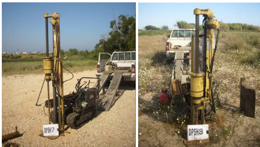
Figura 6.7 – Ilustração da execução dos ensaios DPSH7 e DPSH8
