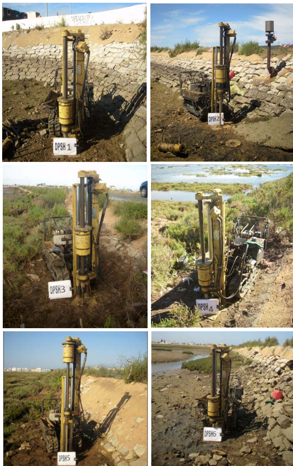
Figura 6.6 – Ilustração da execução dos ensaios DPSH1 a DPSH6
