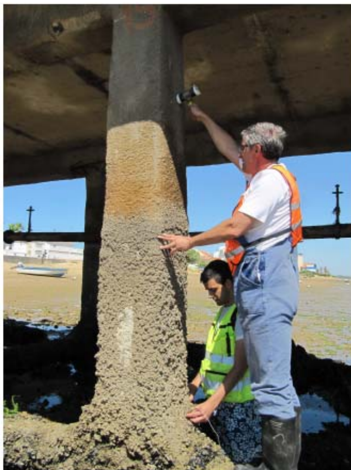
Figura 7.2 – Ensaio realizado na estaca 15, com fonte vibratória colocada 1,8 m acima do geofone instalado junto à viga.
