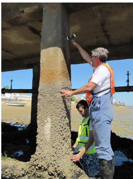
Figura 10 - Ensaio realizado na estaca 15, com fonte vibratória colocada 1,6 m acima do geofone instalado junto à viga.
