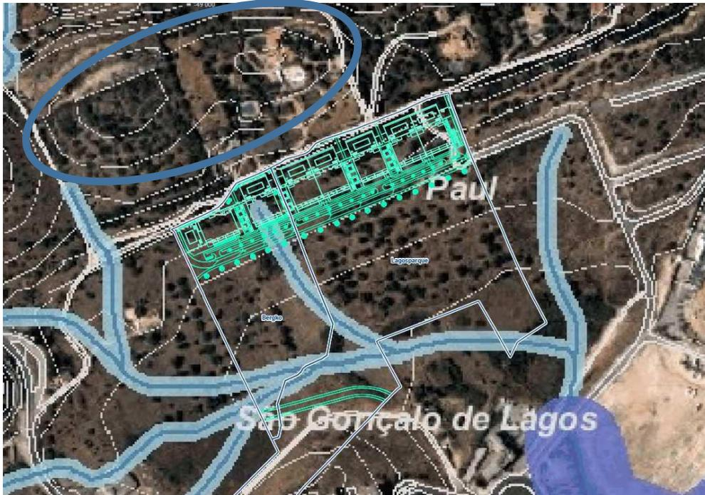
**Figura 6.** Rede hidrográfica local, com implantação dos edifícios. A elipse indica a zona de drenagem a montante dos edifícios.
