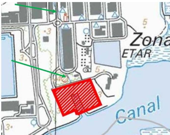
**Figura 6.** Indicação da rede de drenagem estruturante identificada na planta de localização do EIA, as setas verdes indicam a linha de água.
