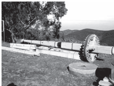
Mastro e entrosga. Moinho Branco de Cachopo, Távira. fotografia GTAA Sotavento
