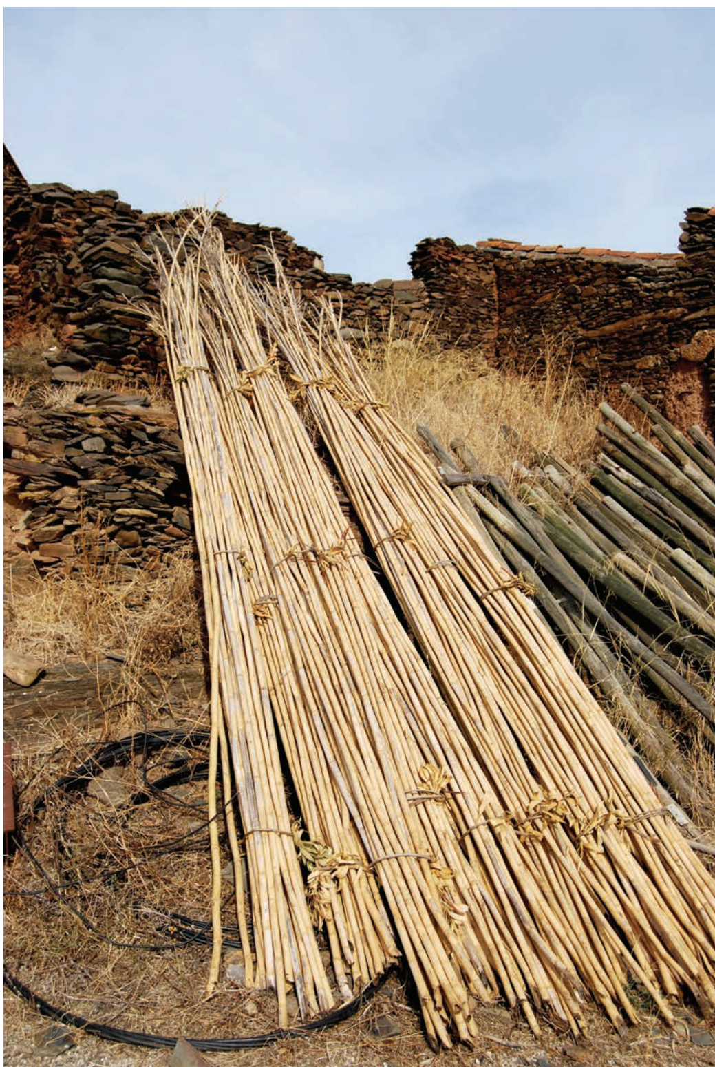
Canas limpas em processo de secagem para posterior utilização na construção. Madeiras, Alcoutim.
