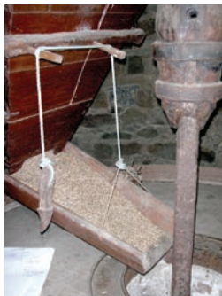
Telha e regulador da telha. Moinho de São Miguel do Pinheiro, Mértola. fotografia Miguel Reimão Costa
